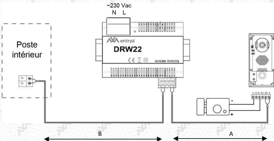
La longueur maximale du câblage est limitée. L'utilisation de câbles différents de ceux prescrits peut influencer sur la longueur maximale du câblage ou provoquer des perturbations.
