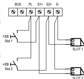
\* met drukknop EB (Exit Button) wordt de tijd voor ontgrendelen van het slot niet bepaald door de instelling van de parameter *Unlock Time* op de binnenpost. Maar wordt het slot zolang ontgrendeld als de drukknop EB wordt ingedrukt.
