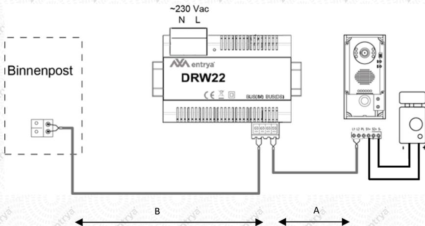
De maximale lengte van de bedrading is beperkt. Het gebruik van andere kabels dan voorgeschreven kan invloed hebben op de maximale lengte van de bedrading of storingen veroorzaken.
