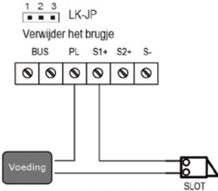
Aansluitschema voor 2 sloten:
