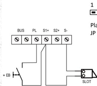
Aansluitschema voor 2 sloten:
