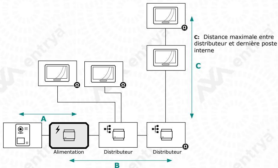
A: Distance maximale entre l'alimentation et poste extérieur
