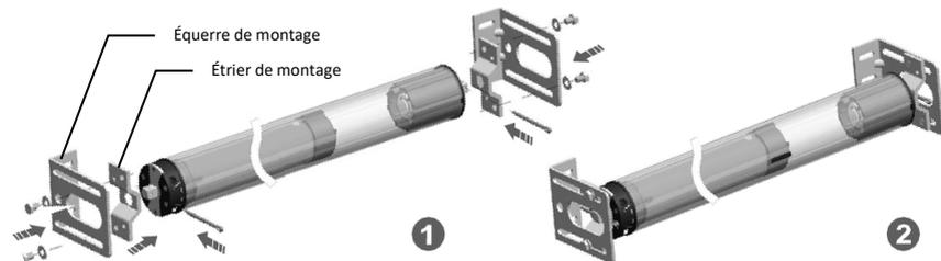
Fixez l'entraînement avec un étrier de montage dans la caisse du volet, utilisez éventuellement des équerres de montage supplémentaires. Pour éviter l'usure prématurée et les bruits lors du fonctionnement, veillez à ménager 1 à 2 mm de jeu entre l'arbre du volet avec les étriers de montage et la caisse du volet ou les équerres de montage.
