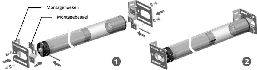
Bevestig de aandrijving met een montagebeugel in de rolluikkast, maak eventueel gebruik van bijkomende montagehoeken. Zorg ervoor dat de aandrijving met de rolluikas en montagebeugels 1 à 2 mm speling heeft tussen de montagehoeken of in de rolluikkast om vroegtijdige slijtage en lawaai te voorkomen.
