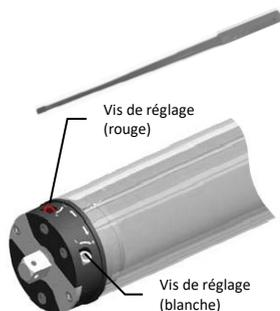
Les grandes flèches à côté des vis de réglage rouge et blanche indiquent le sens de rotation auquel servent les vis de réglage. En tournant la vis de réglage dans le sens "+", l'entraînement ira plus loin dans le sens qui est indiqué par la flèche à côté de la vis de réglage. Tournez la vis de réglage dans le sens "-" si l'entraînement doit s'arrêter plus tôt.
