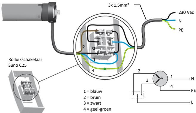
Draaizijn van de motor omkeren: verwissel de bruine (2) en zwarte (3) draden van de motor.
