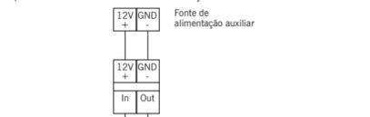
Esquema de conexão para a instalação de mais do que um disparador em série (até ao máximo de 4) e evitar que interfiram entre si. Para tal deve-se conectar o sinal de sincronização OUT ao sinal de sincronização IN do disparador seguinte.
