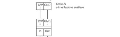
Schema di connessione per l'installazione di più di un trigger in serie (con massimo di 4 trigger) ed evitare che possano interferire tra di loro. Per realizzare questa operazione si deve connettere il segnale di sincronismo OUT al segnale di sincronismo IN del trigger seguente.
